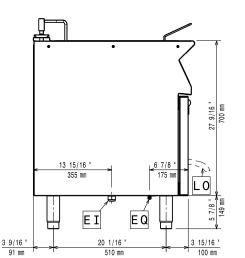
Electrical inlet (power) EQ Equipotential screw
